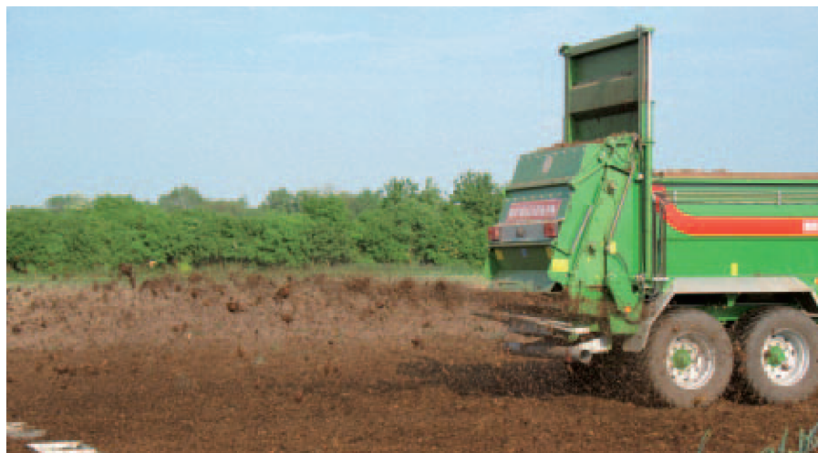
Příčné rozložení rozmetaného materiálu se měří pomocí záchytných nádob umístěných napříč ke směru jízdy.
