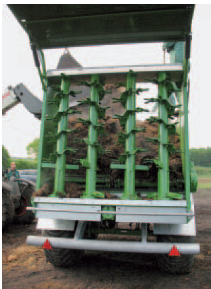
Byly testovány stroje se stojatými a horizontálními frézovacími válci.
