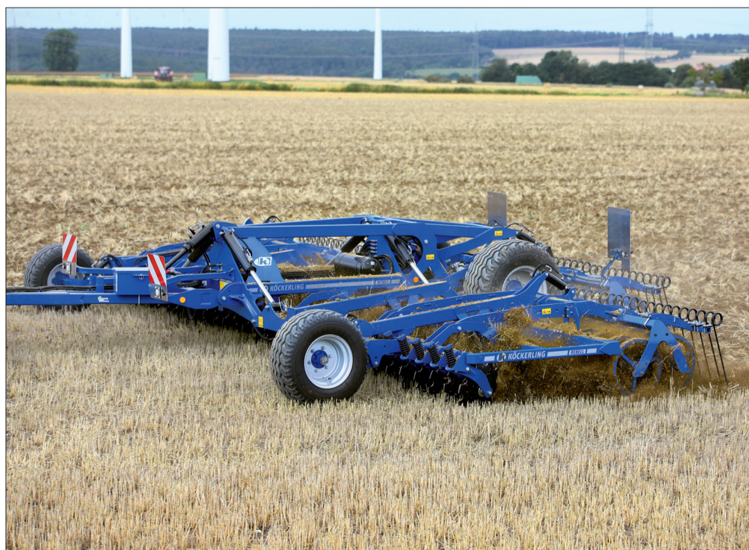
Trio prokypří půdu až do hloubky 30 cm a poté ji urovná a připraví pro následné setí Foto Jiří Hruška
