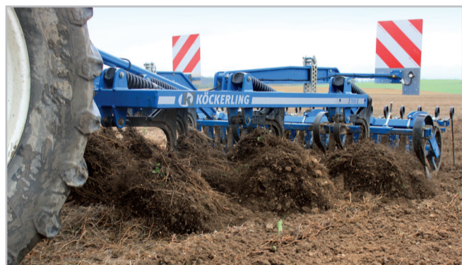
Trio prokypří půdu až do hloubky 30 cm a poté ji urovná a připraví pro následné setí Foto Jiří Hruška
