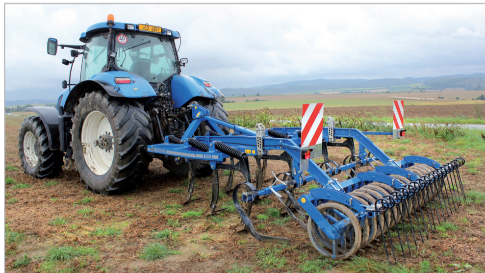
Univerzální kypřič Köckerling Trio je osazen třemi řadami slupic, listovými nivelátory, zadním STS válcem a prutovými zavlačovači Foto Jiří Hruška
