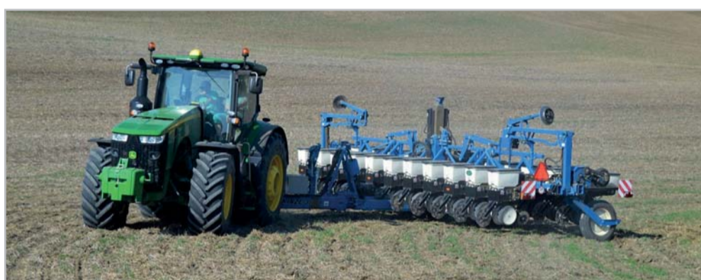
Dvanáctiřádkový přesný secí stroj Kinze 3600 v provedení pro úzkořádkové setí na rozteč 37,5 cm
