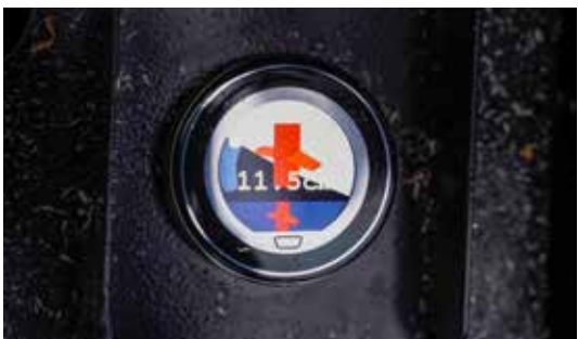
S funkcí X-Aim je štípání automatizované a výsledkem je vysoce kvalitní palivové dřevo i přes různé průměry vstupní kulatiny.
