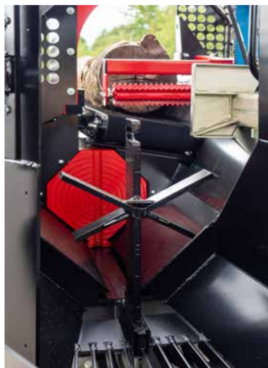
Snadno vyměnitelný hydraulicky nastavitelný štípací klín.
