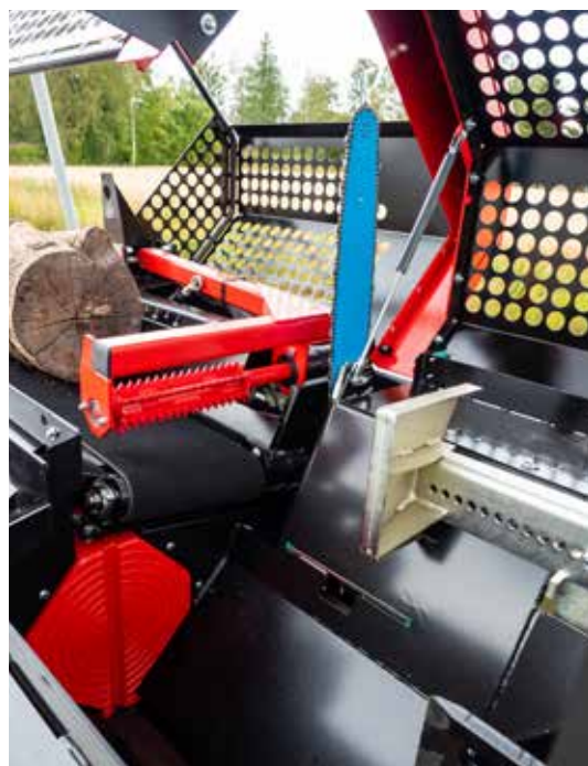
Upínání kulatiny s hydraulickým hnacím válečkem zajišťuje efektivní podávání kulatiny.
