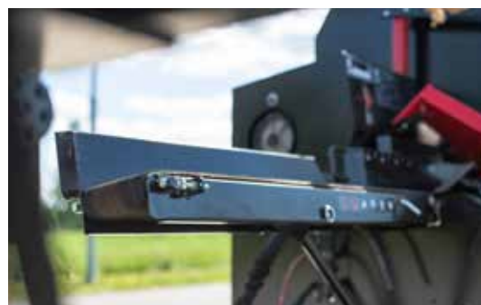
Masivní zadní deska podávacího dopravníku usnadňuje zpracování kulatiny.
