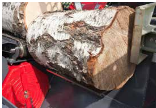
Shazovací deska navádí dřevo přímo do štípacího skluzu.
