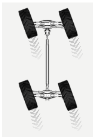
Krab: pojezd stranou do těžko přístupných míst.
