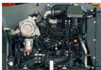
Motor Yanmar 51,7 kW, k dispozici u řady 6.26 Small.
