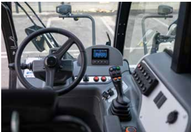
Kabina a proporcionální elektro-hydraulická ovládací páka ve standardní výbavě modelu Big Range Full Electric.
