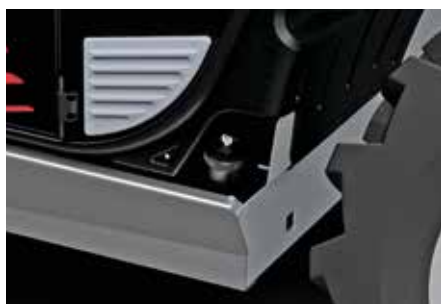
Palivová nádrž je umístěna pod kabinou, která ji tak výborně chrání (standardní verze).
