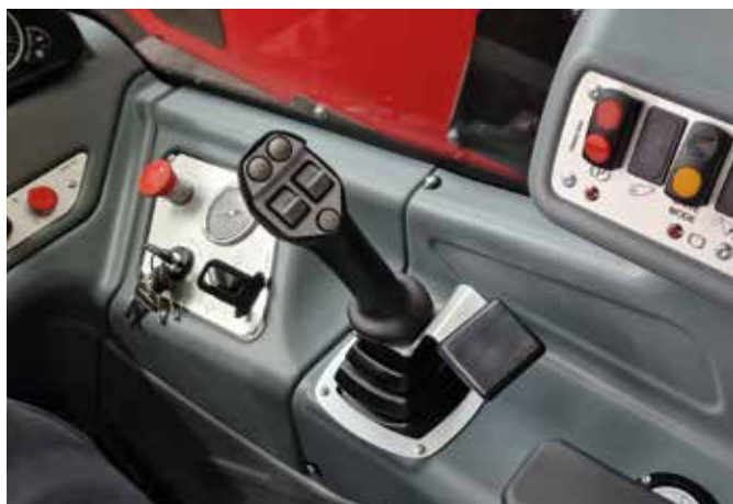
Multifunkční ovládací páka s proporcionálním elektro-hydraulickým ovládáním je ve standardním vybavení ve verzích HLS a VPSe.
