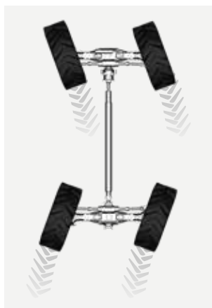
Koncentricky: poskytuje menší poloměr otáčení.
