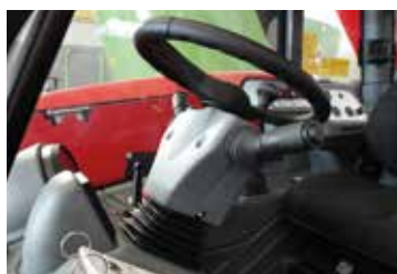
Stavitelný sloupek řízení, pomocí postranní páčky.
