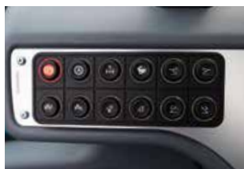
Tlačítková přístrojová deska, u modelů řady Big Range Full Electric je širší.
