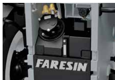
Zásobník hydraulického oleje s hladinoměrem.
