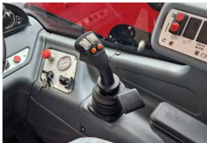
Standardní proporcionálně elektro-mechanická ovládací páka u verzí CLASSIC.
