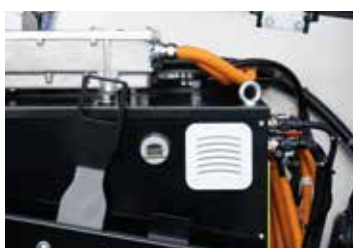
Prostor pro baterii s monitorovacím systémem.
