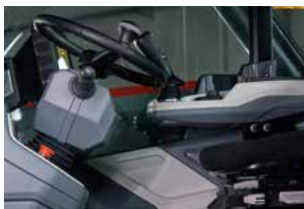
Sloupek řízení sklopný pomocí boční páky.
