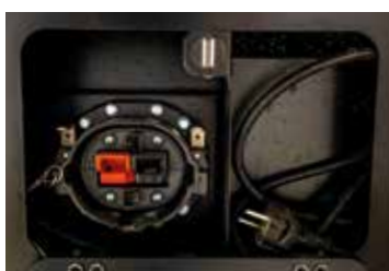
Zásuvka pro nabíjecí stanici, integrovaná na 6.26 Full Electric.
