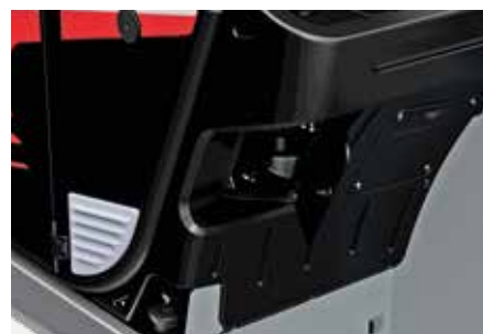
U modelů s motory SCR je vzadu umístěna nádrž na AdBlue.
