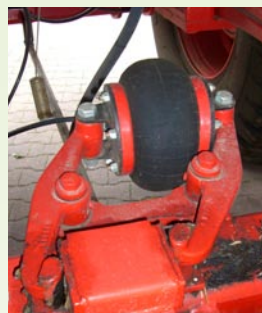
Pneumatický stabilizátor jízdy Zajišťuje uzavírání náprav a komfortní jízdu vpřed.
