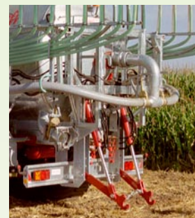
Hydraulika závěsu Umožňuje alternativní připojení aplikátoru (radličkové, botičkové, diskové)
