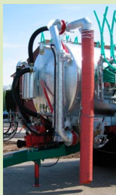
Nasávací chobot S pomocným čerpadlem jistota vysokého výkonu.
