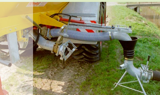
Systém Andock Uplatníte v případech, ve kterých rozhoduje čas. Přijedete, z kabiny traktoru spustíte nástavec a provedete nasátí. Je to rychlé.
