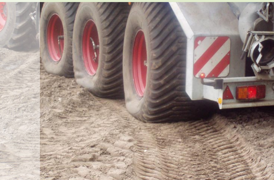
Regulace tlaku v pneumatikách Šetrné k půdní struktuře.
