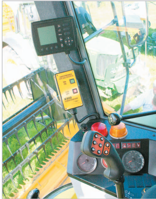
Loketní opěrka s multifunkční pákou se nacházejí vpravo od řidiče Foto Vladislav Fuka
