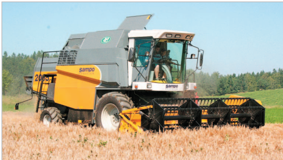
V Horních Duběnkách byl předveden model SR2085 s lištou o záběru 4,5 m. Hmotnost stroje s plným zásobníkem nepřekročí 13 tun, takže kde velké mlátičky stojí, tam Sampo sklízí Foto Vladislav Fuka
