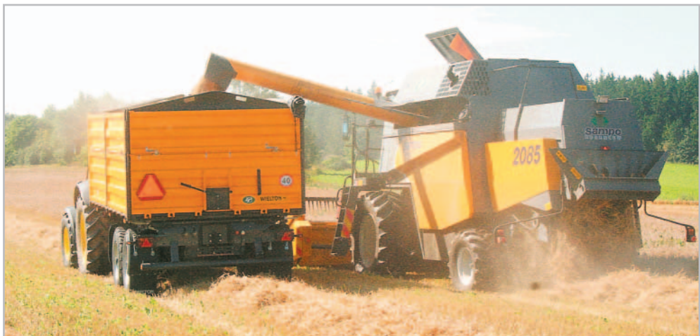
U nových modelů se už vyprazdňují zásobníky rychlostí 70 až 100 l/s, takže i v tomto směru jsou mlátičky Sampo plně konkurenceschopné
