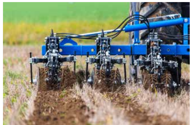
Pokud se pásové zpracování půdy provádí na podzim pro jarní plodiny, lze Eco Tiller seřídit tak, aby struktura půdy byla hrudovitější a profil zpracovaného pásu byl ve tvaru hrůbku. Tím se vytvoří optimální podmínky pro jarní setí.
