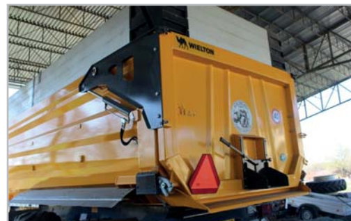
Zadní čelo ovládají hydraulické válce s opačnou logikou, než je běžné. Po uzavření je zadní čelo zajištěno robustním mechanickým zámekem přes vinutou pružinu Foto Petr Beneš
