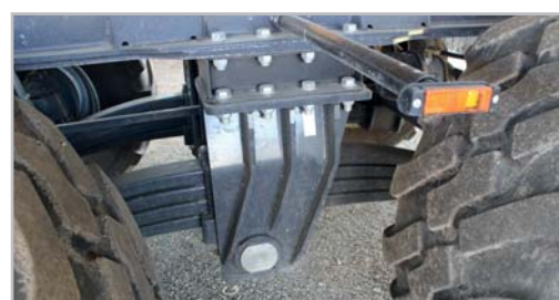
Tandemová říditelná náprava Boogie ADR Parabolic disponuje parabolickým odpružením, kdy jednotlivá pera odpružení jsou masivními výkvyky Foto Petr Beneš
