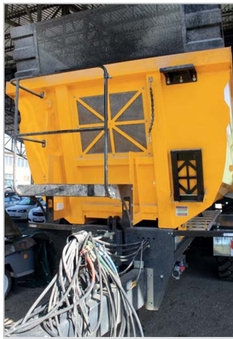
Průzor v čele korby otevírá výhled dovnitř. To samé platí o nástavcích, které jsou v čelní stěně nahrazeny jemnou mřížkou. Také přední žebřík a široká stabilní lávka se zábradlím a protiskluzovým povrchem jsou vyřešeny příkladně Foto Petr Beneš
