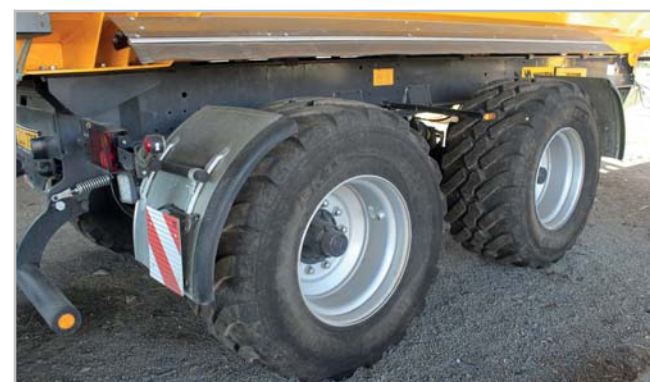
Boogie náprava ADR je konstruována pro zatížení až třiceti tun. Rozvor 2000 mm pak značně zvyšuje stabilitu návěsu Foto Petr Beneš
