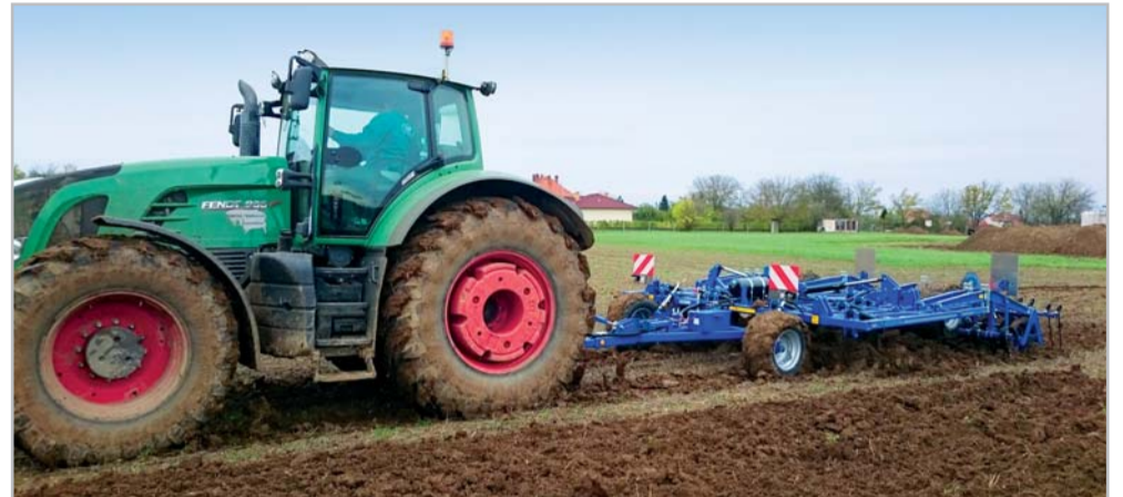
Köckerling Quadro dokáže velmi dobře kypřit půdu i do hloubky 30 cm
