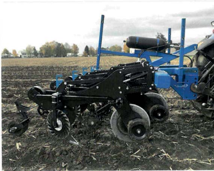
Celkový pohled na krátkou variantu pracovní jednotky (vpředu) a dlouhou variantu (druhá v pořadí) prototypu stroje pro pásové zpracování půdy Foto Antonín Šedek
