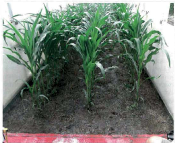
Ověřování protierozní účinnosti technologie strip-till polním simulátorem deště
