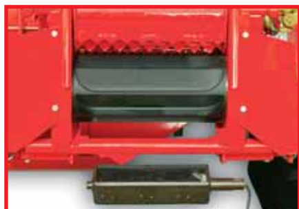
Detektor kovu (zvláštní výbava). Magnetizující cizí tělesa jsou detektorem vysledována a vtahování je ihned zastaveno pomocí západky.
