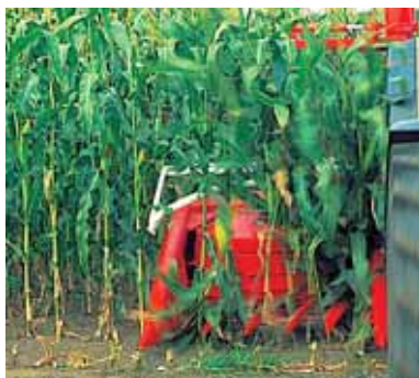
Die Erntevorsätze der Champion-Anbauhäcksler mähen im freien Schnitt, ohne Gegenschneide.
