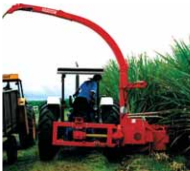
Die Champion-Anbauhäcksler ermöglichen den Einsatz unabhängig vom Reihenabstand und bei unterschiedlichem Erntegut.
