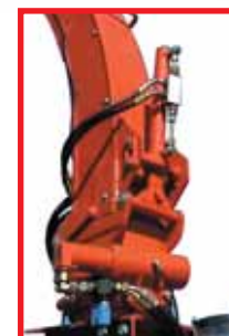
Plynulé otáčení vřacího komínu v rozsahu 300° pomocí hydromotoru. Vyhazovací dvojitá klapka s nastavovacím 12V motorem. Sklápění a vyklápění s pružinovým vyrovnáváním.
