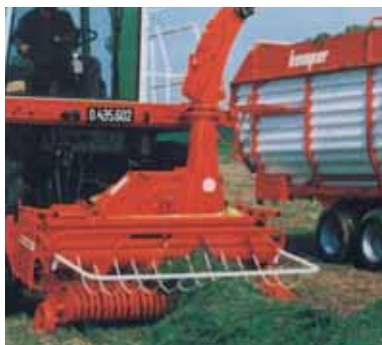
In der Schwadaufnahme können die Champion C 2200/3000 mit einer 2,00 m breiten Pick up zur optimalen Nutzung des Häcksler eingesetzt werden.
