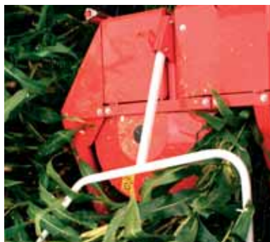
Der Rotationseinzug ermöglicht eine direkte Zufuhr des Erntegutes in Längsrichtung.
