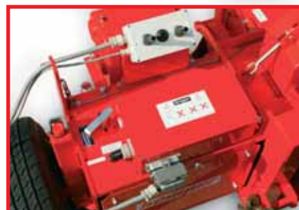
Nastavování délky řezanky (12 délek) pomocí 4 stupňové převodovky, elektrický ovládací modul pro ovládání z kabiny.
