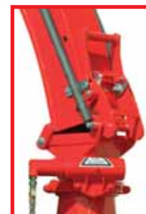
Plynulé otáčení vřacího komínu v rozsahu 300° pomocí hydromotoru. Vyhazovací dvojitá klapka s nastavovacím 12V motorem. Sklápění a vyklápění s pružinovým vyrovnáváním.
