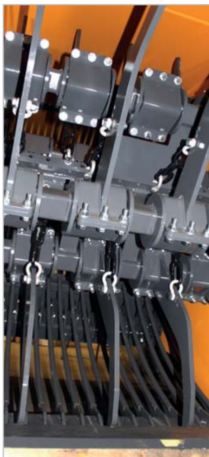
Masivní prsty vkládacího rotoru s pružným uchycením pomocí gumových tlumičů
