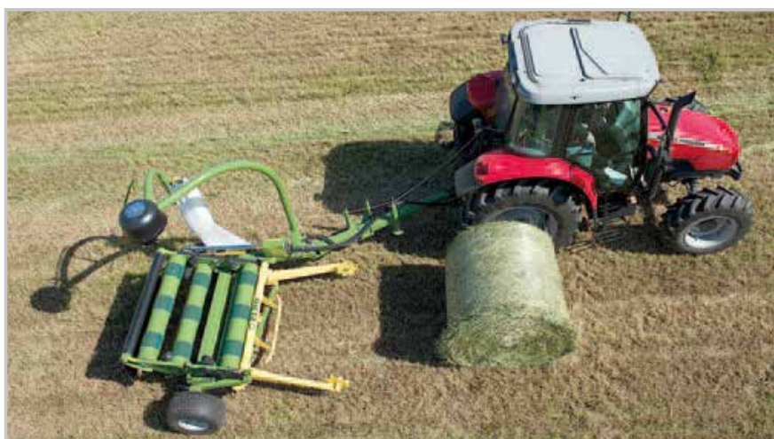
Všechny baličky Sideliner sbírají balíky na poli ve směru řádků a odpadá tak neefektivní jízda „cik-cak“ napříč řádky Foto archiv firmy
