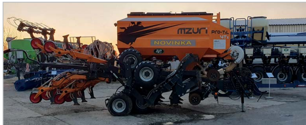
Secí stroj Mzuri Pro-Til 4 TX při jedné jízdě provádí nakypření půdy v úzkých pruzích, aplikaci hnojiv po celé hloubce obdělávaného pásu a výsev osiva do stanovené hloubky
