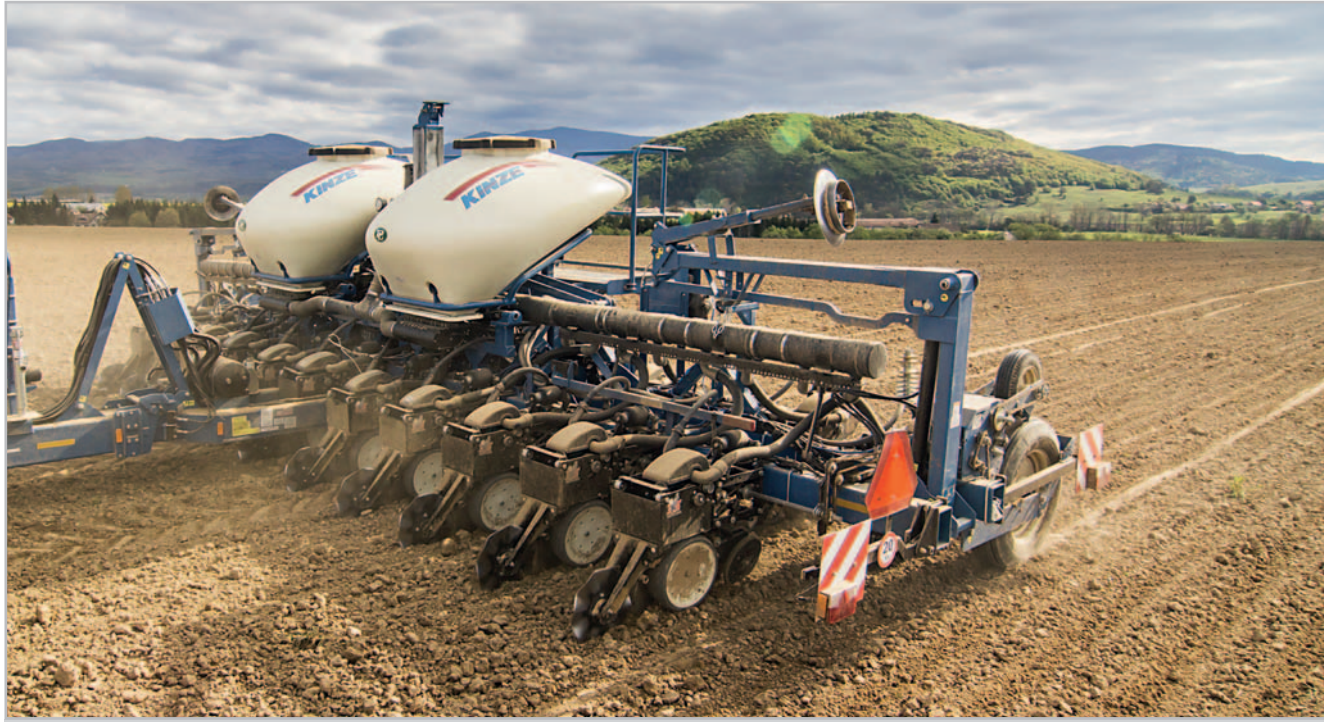
Secí stroj Kinze 3600 Interplant umožňuje vysévání kukuřice s roztečí řádků 0,375 m. To se jeví jako ideální pro účely bioplynových stanic nebo k silážování
