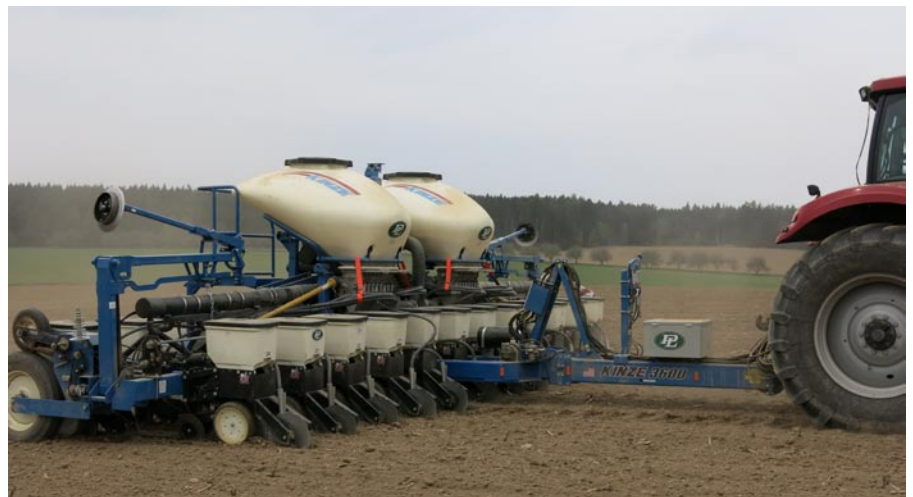
V tomto provedení má secí stroj Kinze ojedinělé technické řešení pro aplikaci startovací dávky hnojiva „pod patu“ pro každou secí botku individuálně
